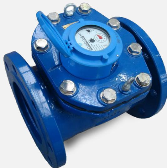
O hidrômetro Woltmann Horizontal modelo LXLC-P é um medidor velocimétrico (de velocidade), com transmissão magnética, relojoaria extra seca.
